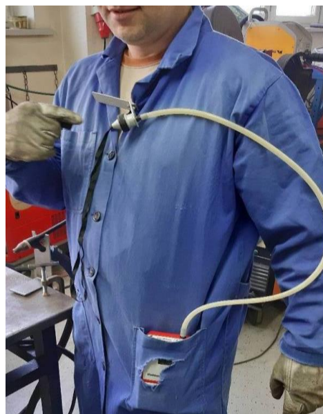
Slika 1. Osebni vzorčevalnik nameščen v območju dihanja operaterja.
