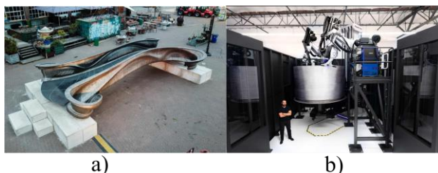
Slika 2: Izdelki velikih gabaritov, narejeni z WAAM: a) most MX3D na sejmu Dutch Design Week 2018 in b) del raketnega motorja Relativity Space [7,10]
