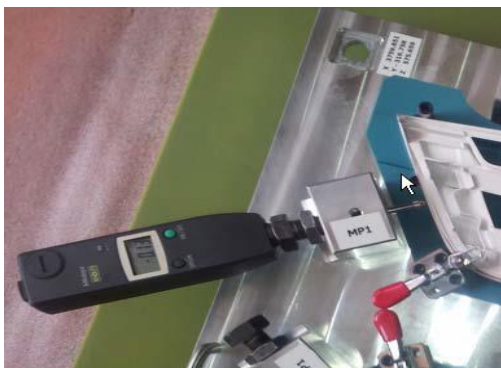
Slika 3: Točkovno merjenje z merilno uro
