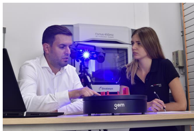
Slika 3: ATOS Q 3D skener za kontrolu kvalitete u razvoju i uhodavanju proizvodnje
