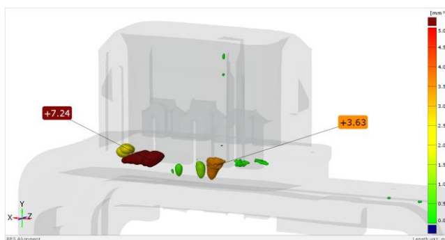
Slika 6: Analiza volumena uključina (lunkera)
