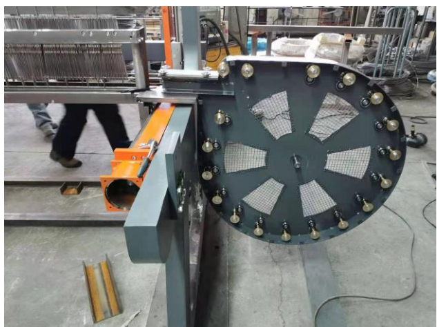
Slika 7: Prototip stroja za tkanje maloserijskih zahtevnih izdelkov iz žice
