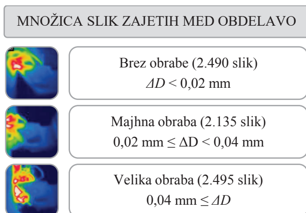
Slika 5: Razdelitev termografskih slik po razredih obrabe
