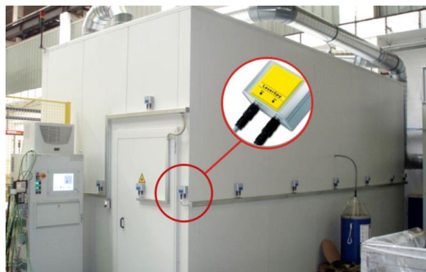
Slika 9: Aktivna laserska zaščita
