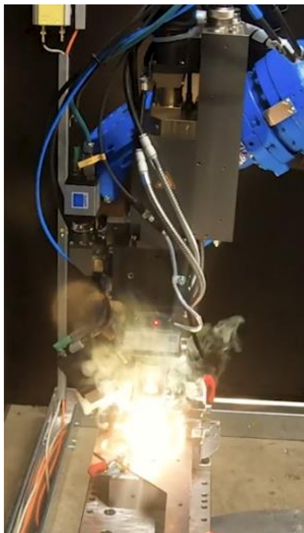
Slika 8: Laserski varilni proces na zvarnem spoju
