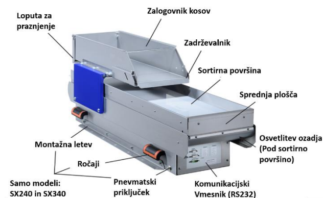
Slika 2: Sestavni deli Anyfeeder naprave
