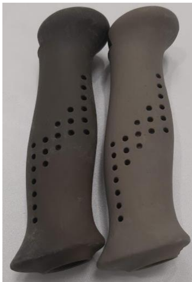
Slika 4: Slika ročajev za smučarske oz. pohodne palice iz termoplastičnega elastomera z dodanim odpadnim usnjem (levi brez barvila, desni z belim barvilom)
