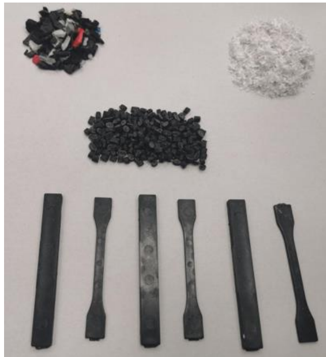
Slika 1: Reciklat polipropilena, odpadni papir, granulat biokompozita z 10 % odpadnega papirja in brizgani vzorci za testiranje
