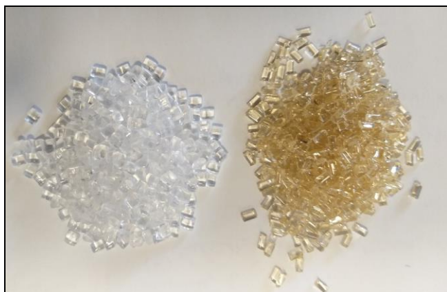
Slika 1: Granulat brez predelave (levo) in po 10. predelavi (desno)
